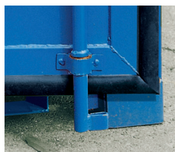
Tür mit Dichtgummi und Verriegelungsstange
